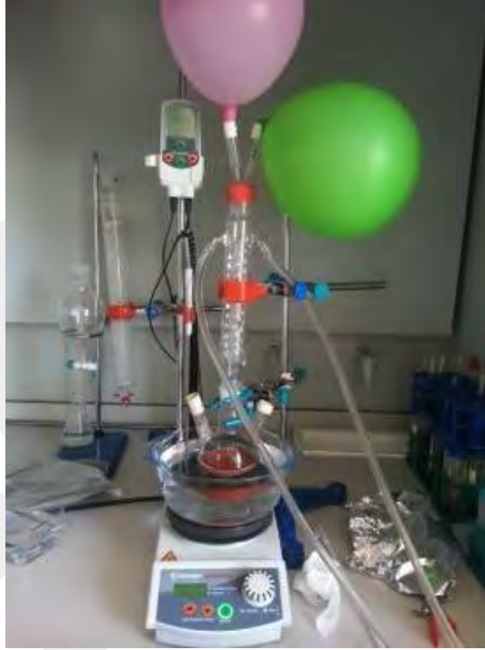
Şekil 1. Azot altında yapılan çalışmayı gösteren deney düzeneği
