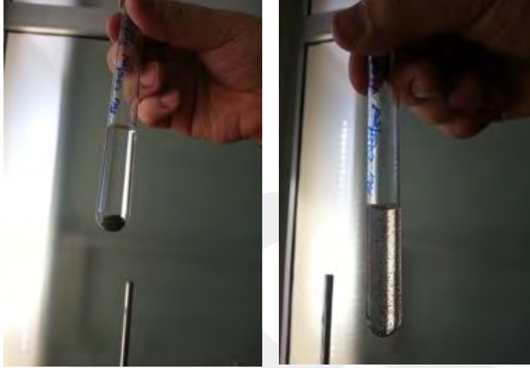
Şekil 5. AgNW'ların altın kaplandıktan sonra agregasyona uğraması
