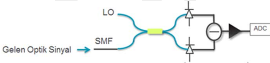
Şekil 6. Tek modlu fiber temelli eş fazlı algılama sistemi
