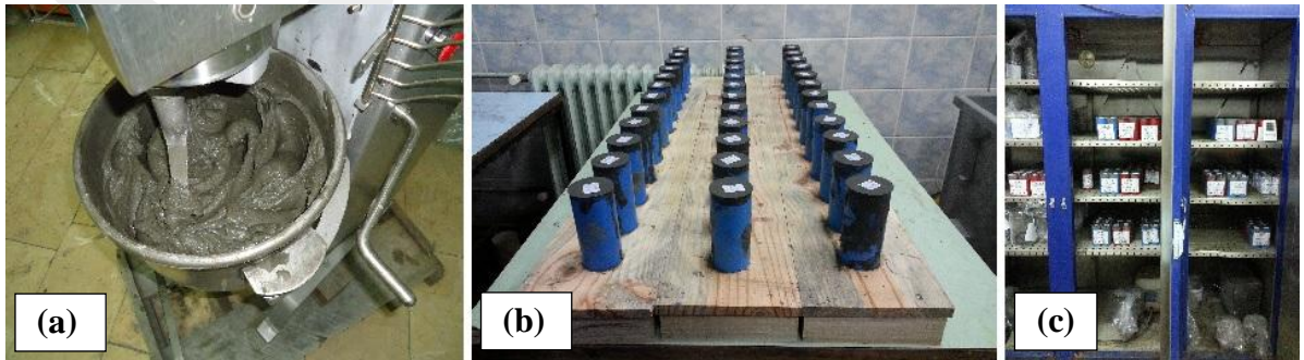
Şekil 3. Karışımların hazırlanmasında kullanılan mikser (a), numunelerin drenaj (b) ve kür işlemi
