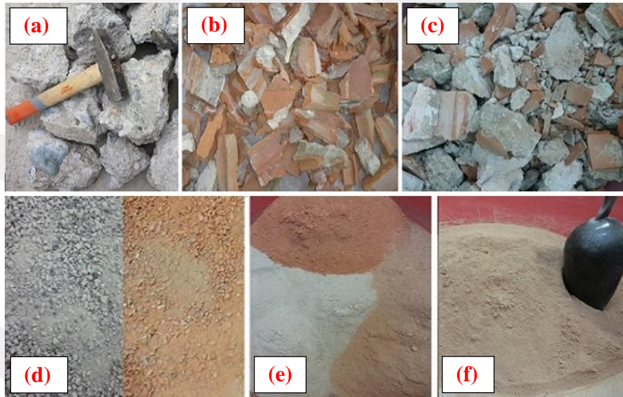
Şekil 1. İA'nın beton-agrega (a), beton-tuğla-kiremit (b) ve harç-tuğla-beton (c) karışımı olarak sınıflandırılması, kırma (d), öğütme (e) ve karıştırıldıktan sonraki görünümü (f) (Yılmaz ve diğ., 2018)
