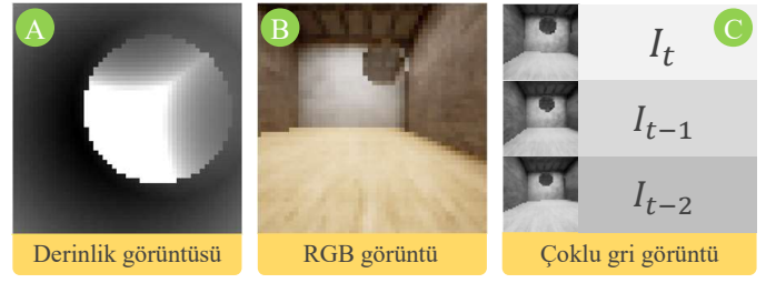
Şekil 2: Derin pekiştirmeli öğrenmede kullanılan üç farklı girdi çeşidi için örnek imgeler. A) Derinlik görüntüsü, B) RGB kamera görüntüsü, C) birleştirilmiş ardışık üç gri tonlu görüntü.
