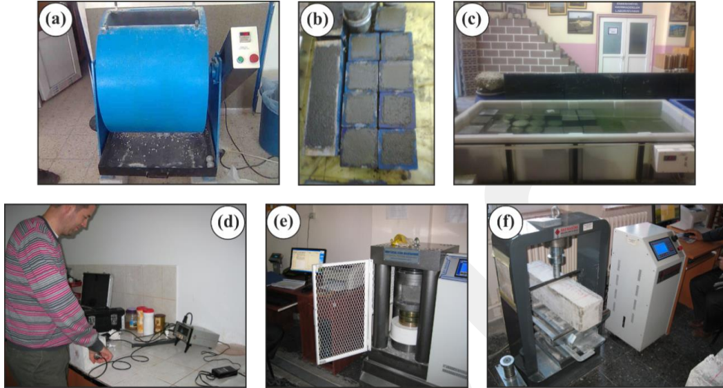
Şekil 2. Laboratuvar çalışmaları a) Beton agregalarında LAA testi b) Beton numunelerinin kalıplara doldurulması c) Kütleme işlemi d) Beton numunelerinde P dalgası ölçümü e) Tek eksenli basınç deneyi f) Eğilme deneyi (Laboratory studies: a) LAA test for concrete aggregates b) Filling concrete samples into the molds c) Curing process d) Pulse wave velocity measurements for concrete samples e) Uniaxial compressive strength test f) Flexure strength test)
