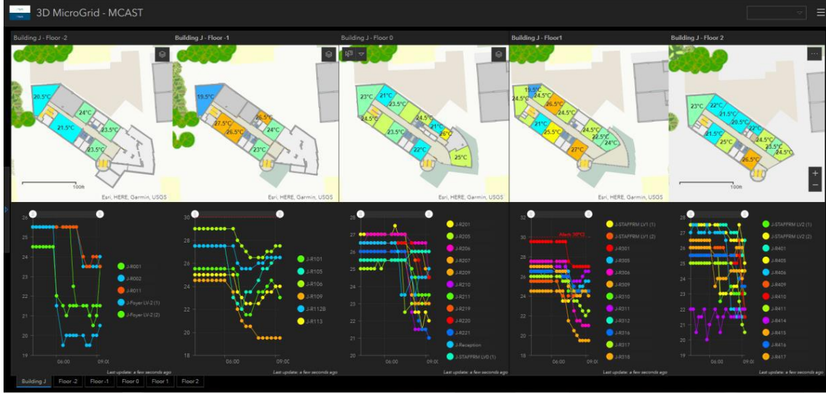
Şekil 4.15. J binasının sıcaklık eğiliminin genel görünümü
