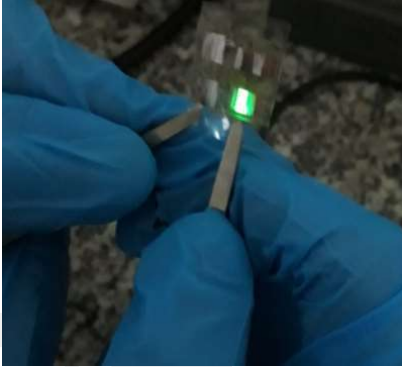
Şekil 102. Yeşil ışık yayan esnek PET tabanlı QLED
