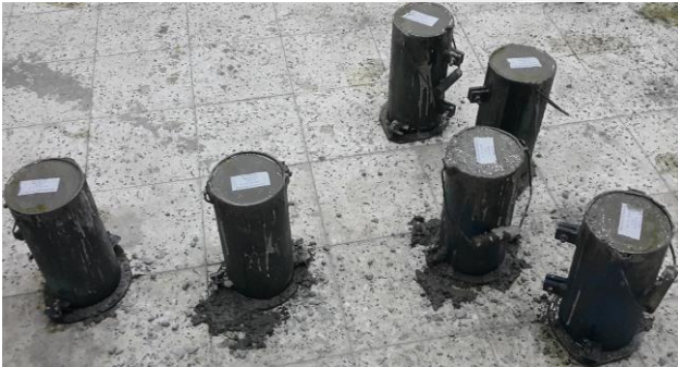
Şekil 1. Kalıplanan silindirik beton numunelerden birkaçı
