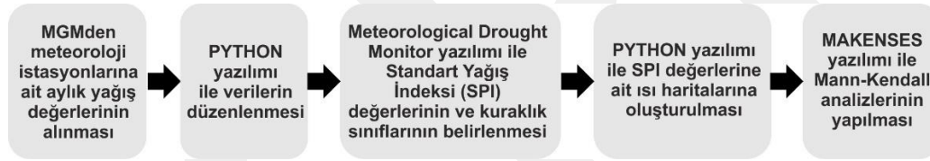
Şekil 2: Çalışmada kullanılan yöntemle ait iş akış şeması
