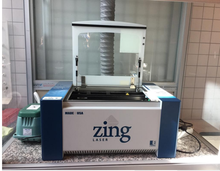
Şekil 21. Lazer kesici ve havalandırma sistemi.
