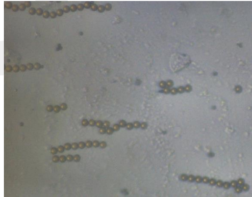
Şekil 28. Dış manyetik alan altında mikro-parçacıkların topaklanması.
