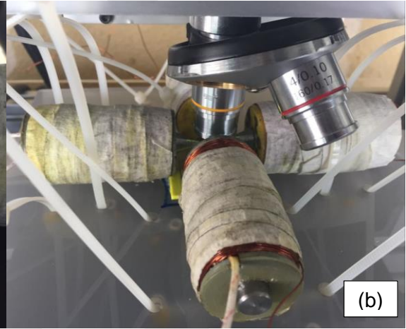
Şekil 15. İki ve dört elektromıknatıstan oluşan deney düzeneği.
